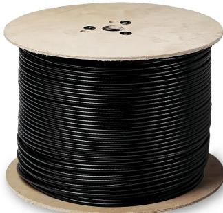
Cavo di rete da esterno CAT 5E con guaina in PE nera, matassa da 500 metri composto da 4 coppie bilanciate da 100 Ohm con conduttori in rame rosso flessibile AWG 24. Le caratteristiche soddisfano i requisiti di **Cat. 5E Classe D** fino a 100 Mhz secondo gli standard ANSI/TIA 568.2-D e ISO/IEC 11801. Idoneo per applicazioni Gigabit Ethernet (IEEE 802.3ab).
